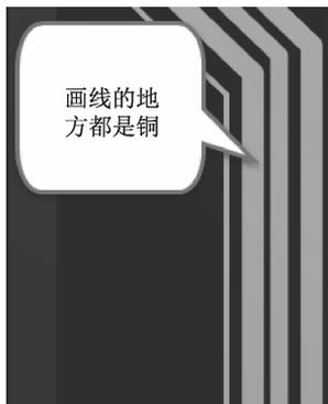
图 3-2 正片层走线示意图
