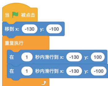
图 1-3-2 控制灰色方块运动的代码
