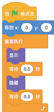
图 1-6-2 控制“绿点”角色闪现的代码
