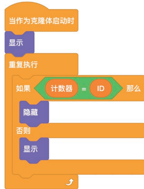
图 1-5-3 控制小球克隆体显示或隐藏的代码
