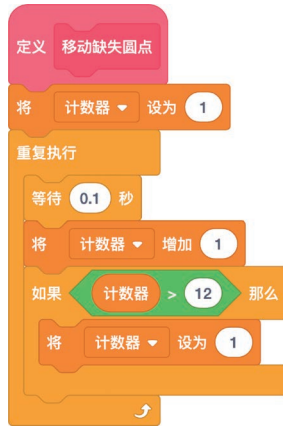
图 1-5-3 控制小球克隆体显示或隐藏的代码
