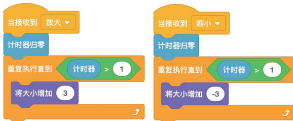
图 1-4-4 控制“绿色球”角色放大和缩小的代码
