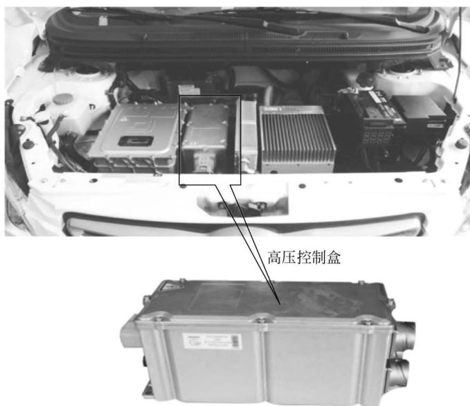
图 1-3 分体式高压配电系统
