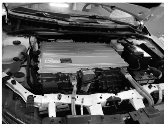
图 1-5 高度集成式高压配电系统
