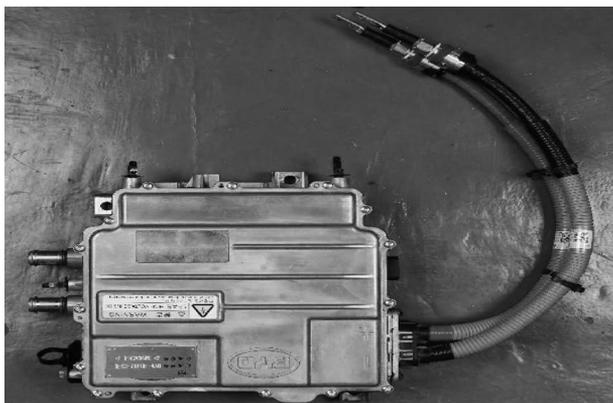
图 1-10 电机控制器
