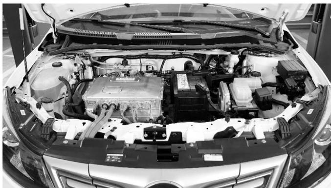
图 1-4 集成式高压配电系统
