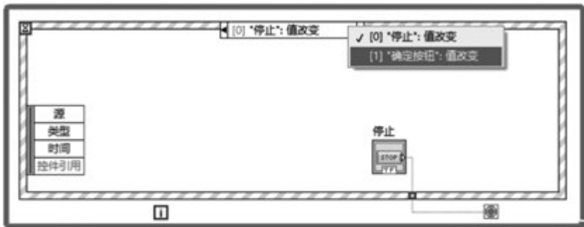
图 3-66 事件响应模式程序框图
