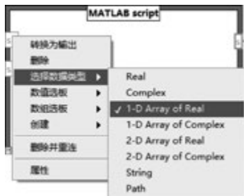
图 3-55 定义 MATLAB 脚本节点输入参数的数据类型
