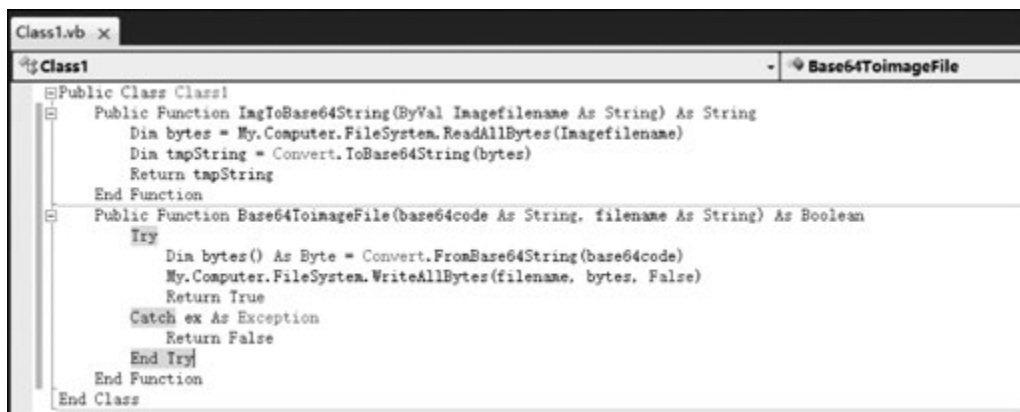
图 3-37 VB.NET 中 DLL 函数设计相关代码
