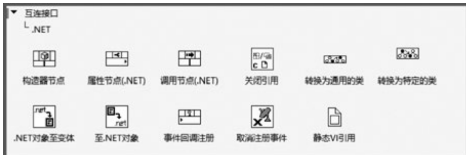
图 3-40 添加函数节点“构造器节点”
