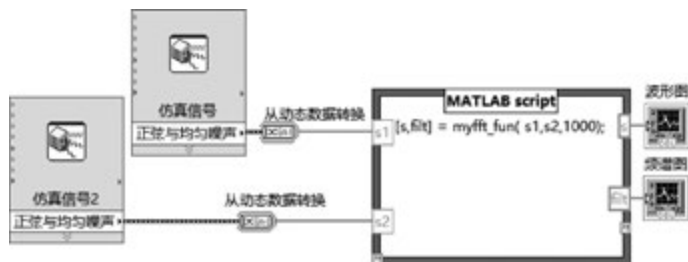
图 3-59 MATLAB 脚本节点调用自定义函数
