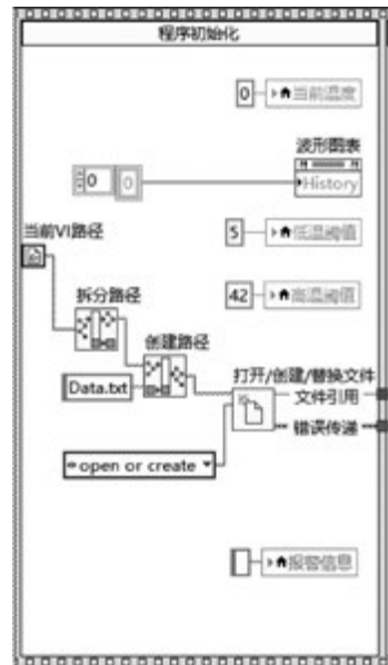
图 3-88 初始化帧程序框图
