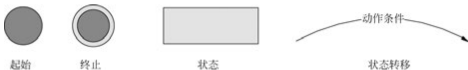
图 3-82 表示状态图的 4 种主要图元
