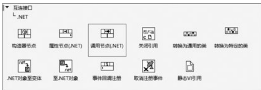
图 3-42 添加函数节点“调用节点”
