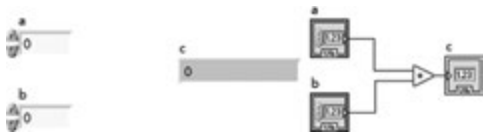
图 3-22 “Add_Int. vi”前面板和程序框图设计
