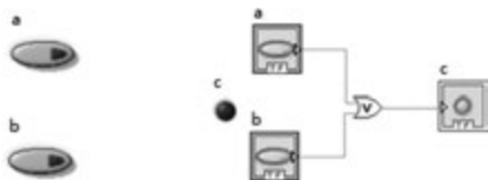
图 3-24 “Add_Bool.vi”前面板和程序框图设计
