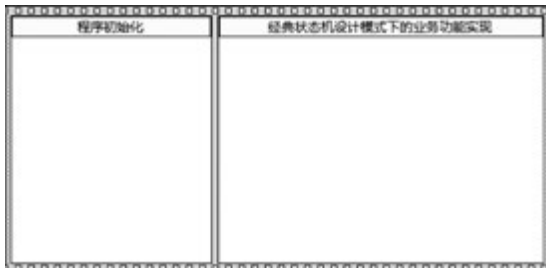
图 3-87 顺序帧框架下的程序框图的总体结构
