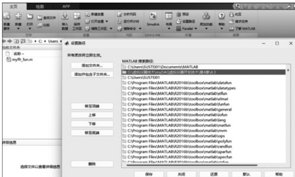
图 3-61 将自定义函数文件所在文件夹作为 MATLAB 搜索路径之一
