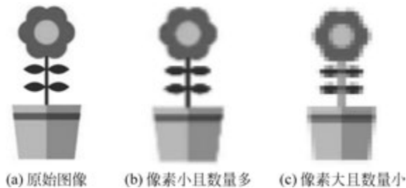
图3-2 图像分解成不同像素数量的效果
