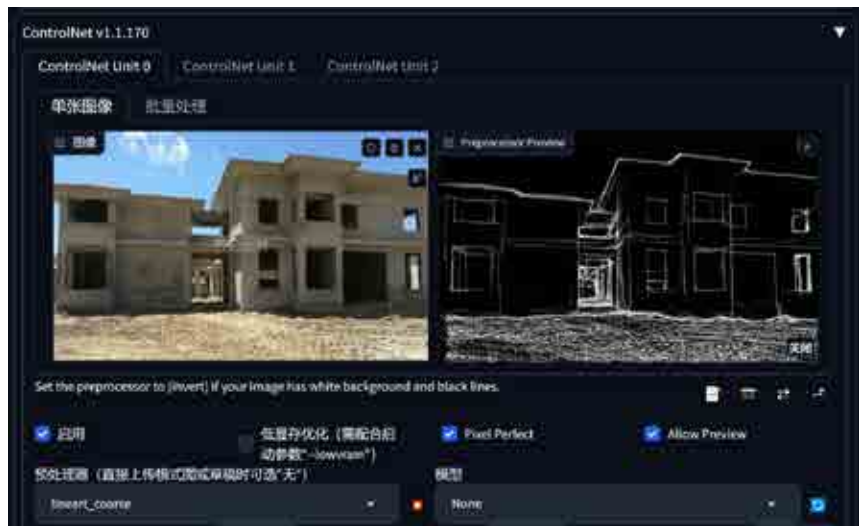
图 1-37 ControlNet 识别毛坯房结构
