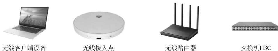
图 5.8 无线网络的基本组成设备
