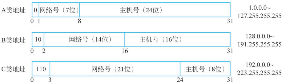
图 5.7 IP 地址编码示意图
