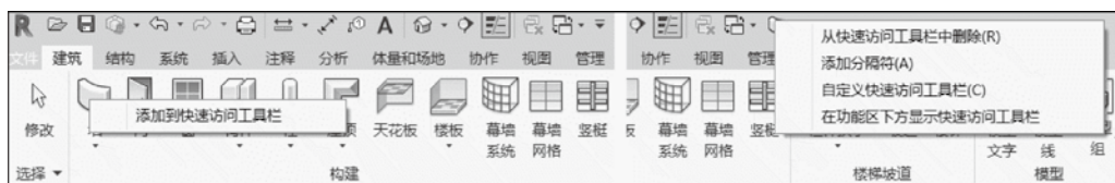
图 1-8 将“墙”工具添加到快速访问工具栏
