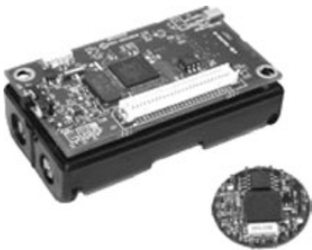
图 5.9 MICA2 系列 MPR4x0(左上)和 MICA2DOT 系列 MPR5x0(右下)的实物
