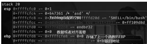
图 5-30 函数栈的布局 2
